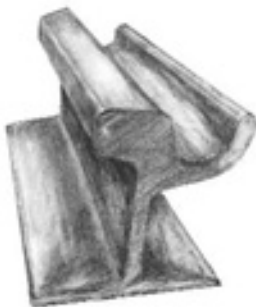
Carril Phoenix o de Garganta, utilizado en las ciudades, que deja el riel del tranvía enterrado en la calzada.
